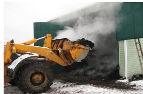
Компостирование в биоферментаторе при температуре 60° С в течение 7 суток
